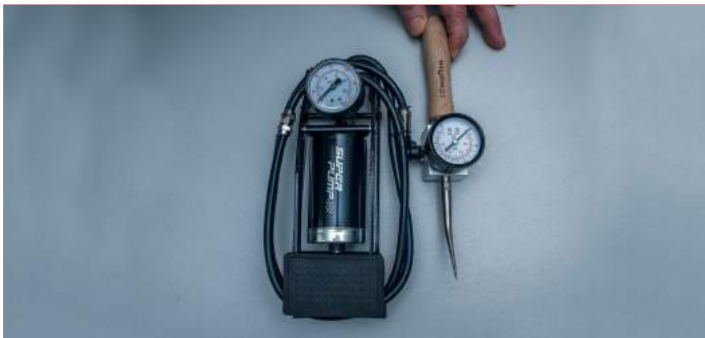
Проверочная игла с насосом
