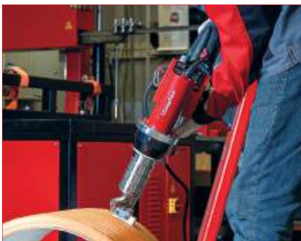
Сварка труб и ёмкостей
